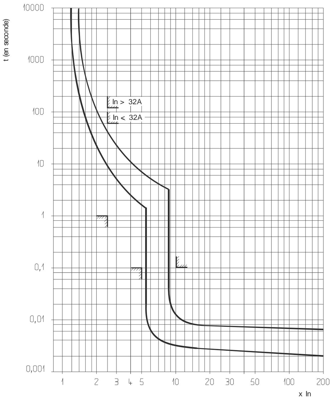
Déclenchement thermique temp. ambiant = 30°C
